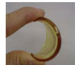
硬化後も柔軟で躯体の動きに追随します
