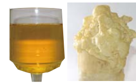
水のないところではそのまま硬化(左) 水と接触すると発泡し止水(右)
